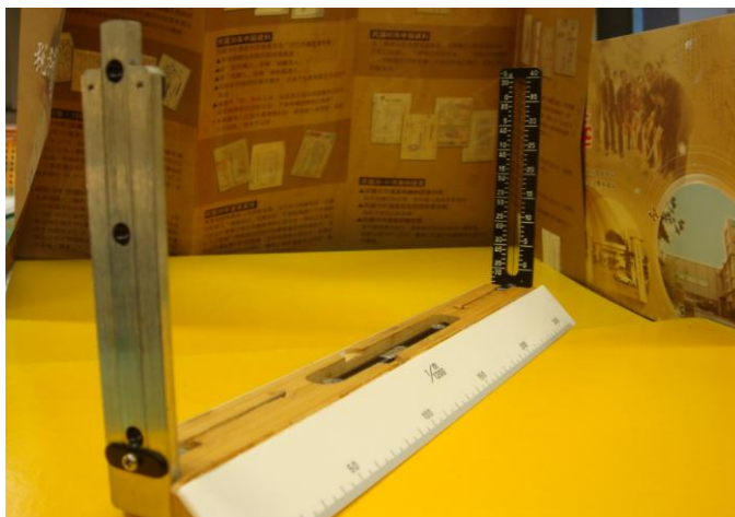
圖 3：小平板儀是使用測斜照準儀，照片前方的覘孔板 3 個圓孔為眼睛照準遠方標竿時使用。
