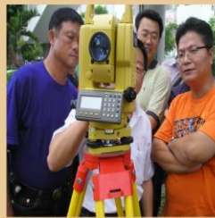
目前最新經緯儀加入了新功能：探雷射測距，可免用棱鏡測距，使測量更為簡便。
