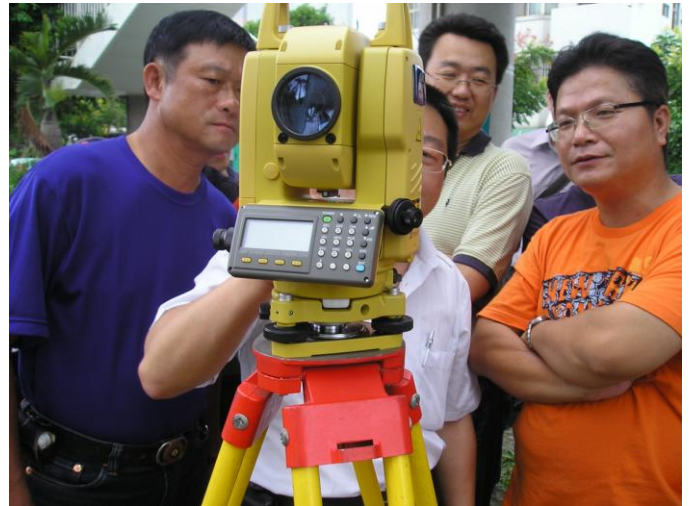
圖 10：目前最新經緯儀加入了新功能：採雷射測距，可免用稜鏡測距，使測量更為簡便。
