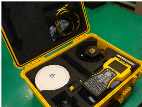
圖 18: GPS 接收器包含天線、接收儀、控制器、供電設備與配件。
