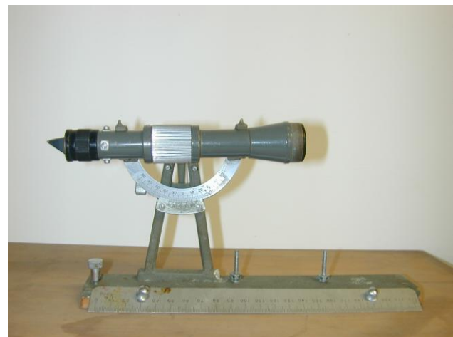
圖 4：大平板儀是使用望遠鏡式照準儀，日本製含直角目鏡，約 1988 年出廠。
